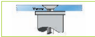
Fixation par cabochon fraisé sur plateau verre
