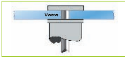
Fixation sur plateau verre avec cabochon plat
