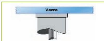
Fixation par collage UV sur plateau verre
